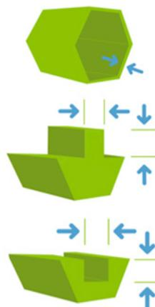
Spessore min. parete: 1,00 mm - Dimensione min. dettaglio: 1,00 mm
