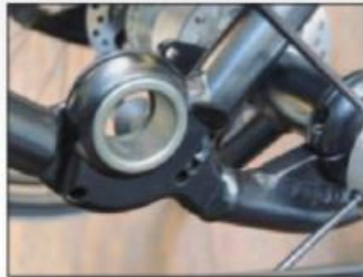
Links das Faltelement zum Zusammenklappen des Rollstuhls, rechts das Gelenk des Handhebels, gefertigt und optimiert von Proto Labs
